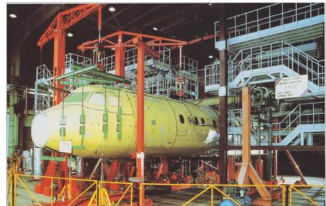
Fig. 18 – L'ATR42 sottoposto alle prove di fatica nel Laboratorio Esperienze Aeritalia
