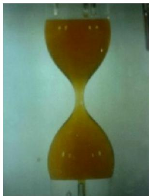
*Fig. 9 – Ponte liquido realizzato con la tecnica di Plateau presso i laboratori Kodak di Londra*
