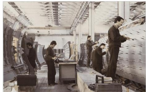
Fig. 15 – Lavorazione dei pannelli di fusoliera del DC-9
