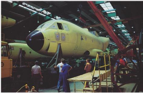
Fig. 16 – Montaggio della fusoliera del G222
